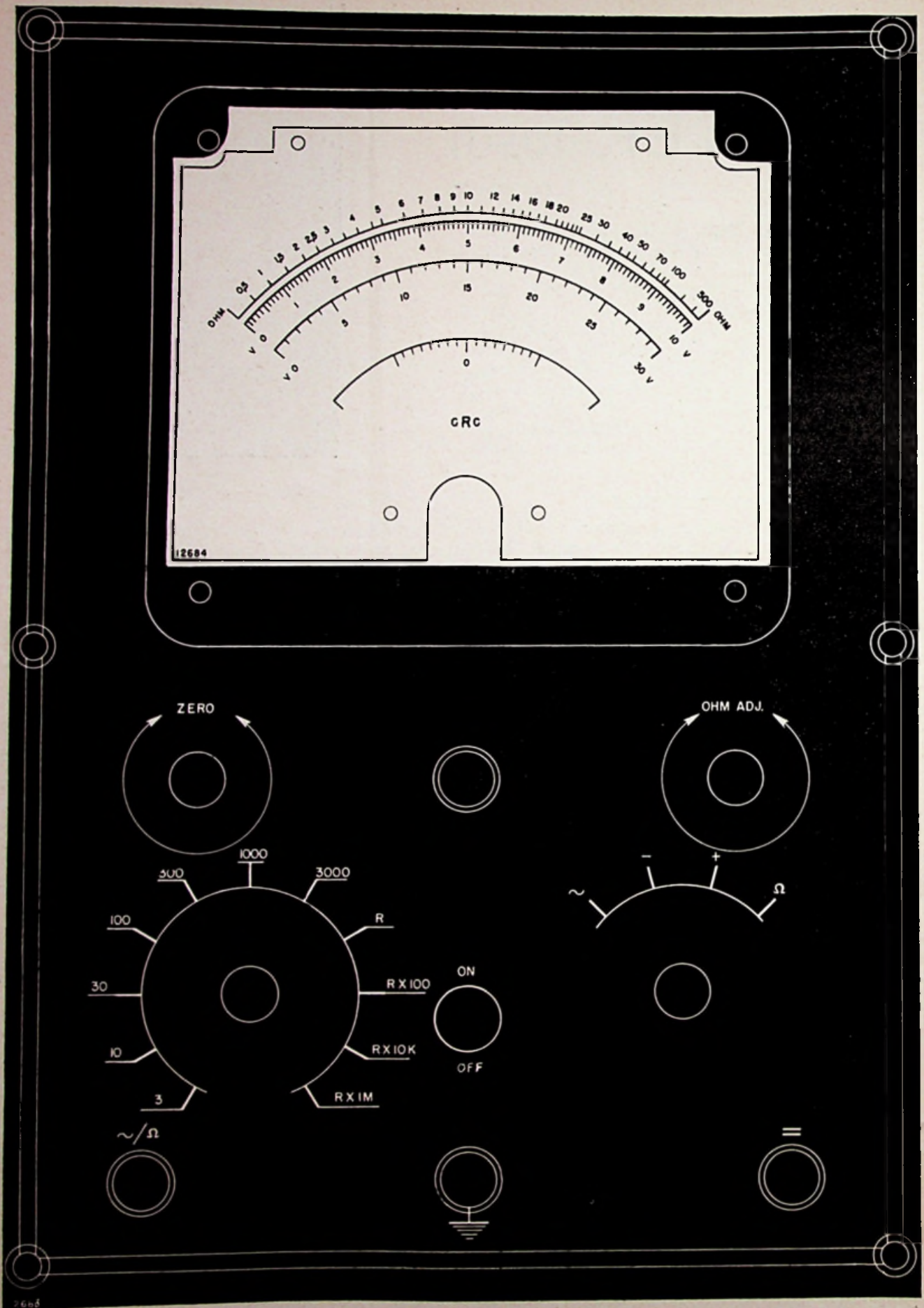
Fig. 4. — HET VOORPANEEL VAN DE BUISVOLTMEETER 10.501 OP WARE GROOTTE. In de opening is de met het meetinstrument te gebruiken nieuwe schaal afgedrukt. Zelfbouwers, die het toestel willen nabouwen en hun Revue niet wensen te beschadigen kunnen, op aanvraag, een afzonderlijke afdruk bekomen.
